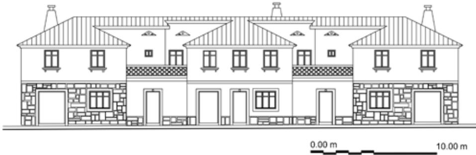
Fig. 11. Composición del alzado de la tercera fase. E: 1/200
